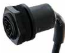
SM-059556 Přípojovací kabel s konektorem „samice“ – délka 6 m Přípojovací kabel s konektorem „samice“ k instalaci pro sloupy veřejného osvětlení. Druhý konec kabelu je bez konektoru. IP68, maximální zatížení 20A.
